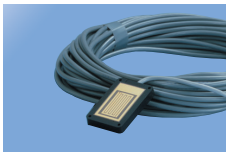
雨センサー RH-1 (基板式) ●感部：くし形電極雨センサー・ヒーター付 ●端子：1.25-YASS4 ●付属ケーブル：0.3mm×3芯 VCTF 15m
