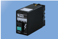
避雷器 MAX-200 ●使用温度範囲：-5℃～+55℃ ●使用湿度範囲：30～90%RH（結露しないこと） ●最大食荷電流：5A ●異常表示：ヒューズ断線時に異常表示 穴にて白色で表示
