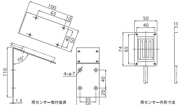
■ 降雨警報器寸法図(単位:mm)
